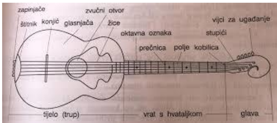
Slika 5. Dijelovi tambure (Leopold, 1995: 19)
