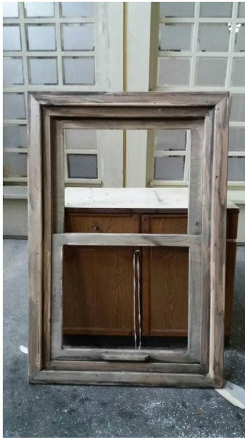
Slika 33. Izrađeni prozor u radionici SNP
