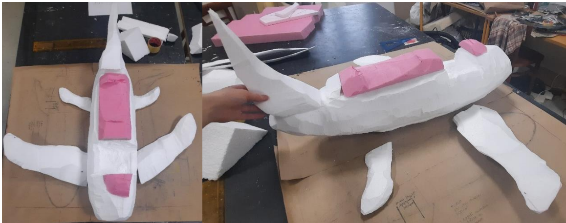
Slika 25: Izrada tijela aviona
