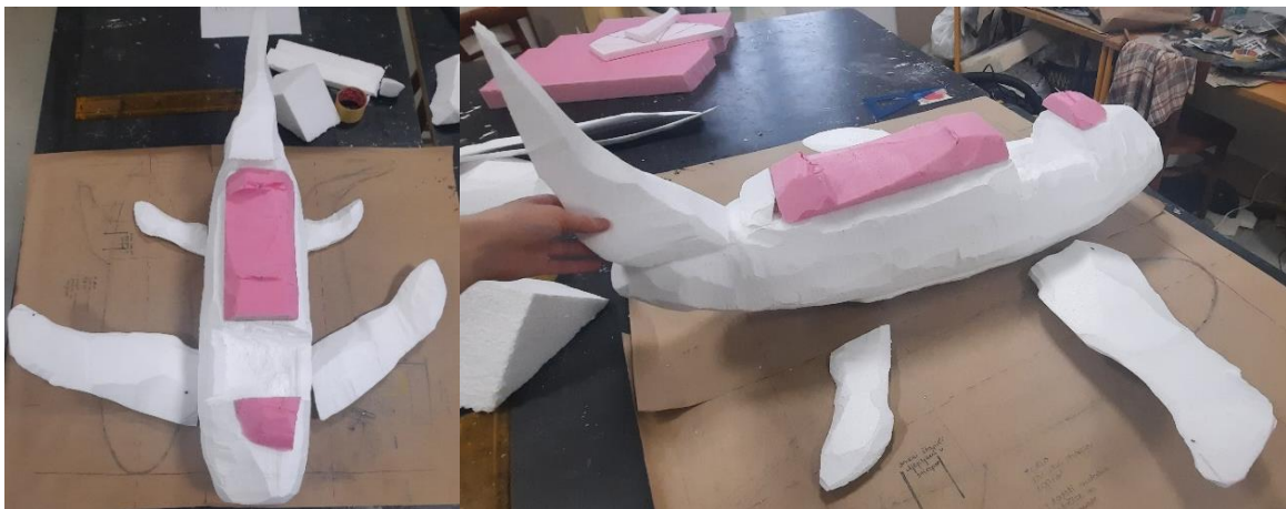
Slika 25: Izrada tijela aviona
