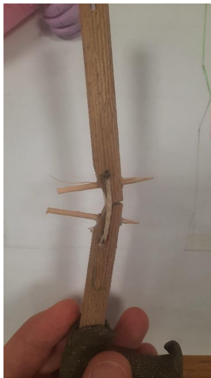
Slika 17: Spoj tapetarskom gurnom učvršćen čačkalicama
