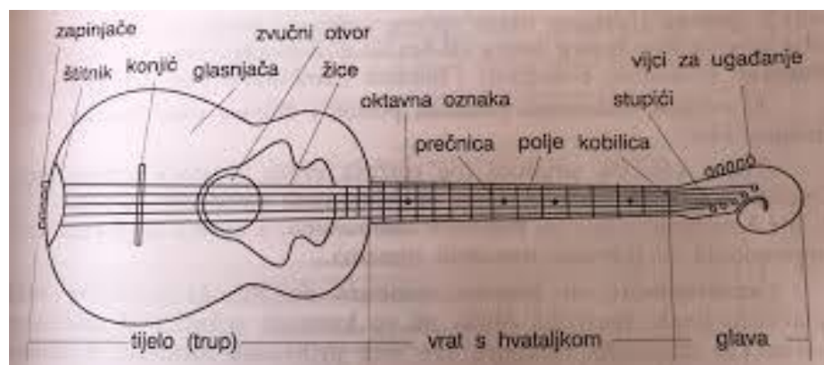
Slika 3. Dijelovi tambure (Leopold, 1995: 19)
