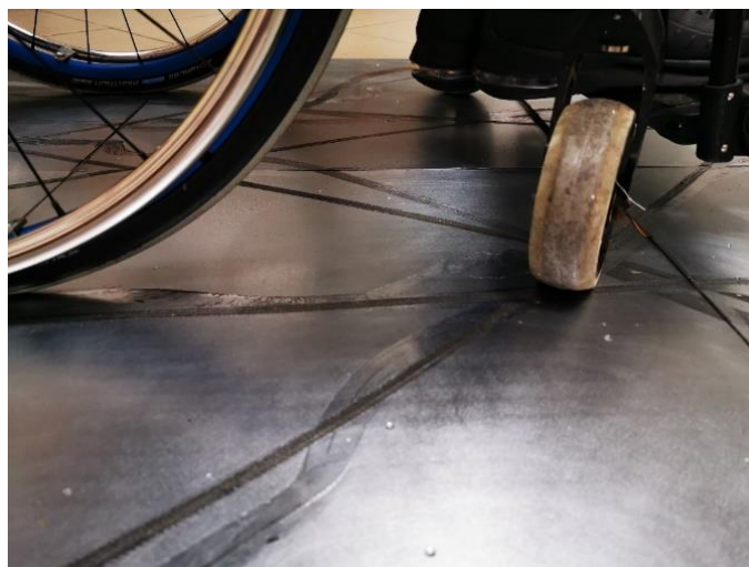
Slika 10. Prikaz procesa rada: prelaženje kolicima preko cinčanih ploča premazanih vazelinom
