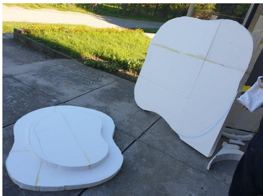
Slika 5. Izgled stiropornih ploča u procesu rezanja.
