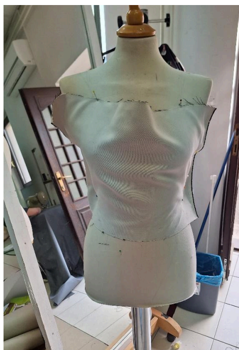
Slika 8. Tkanina koja nije pod kutom od 45°, prisilno namještena u oblik
