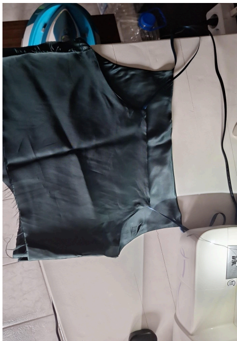
Slika 14. Gornji dio sašiven, ostavljena jedna strana zbog zatvarača
