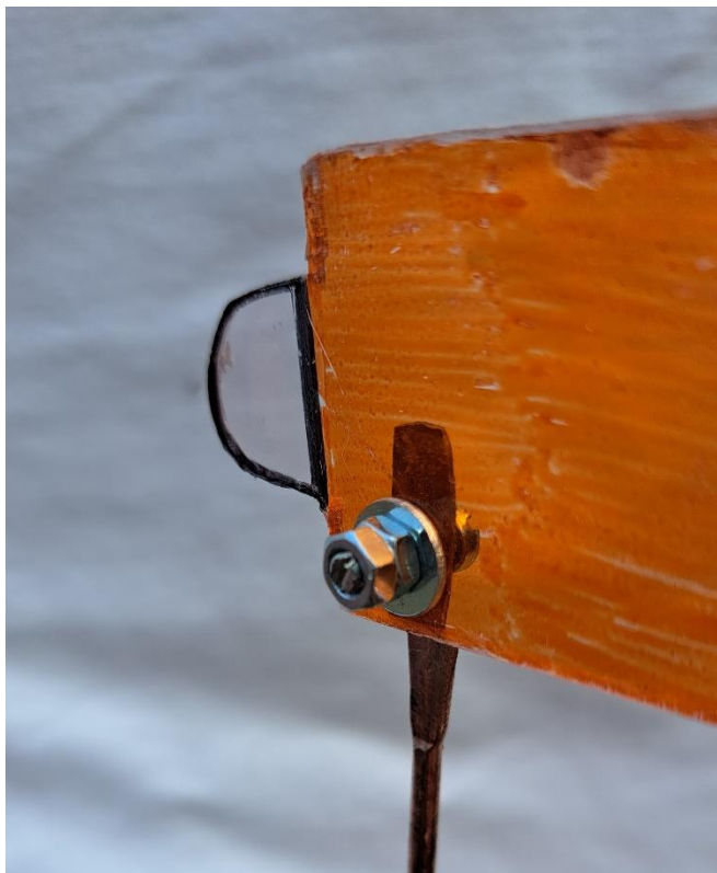
Slika 14. Krupni prikaz spoja vodilice i ruke sa stražnje strane
