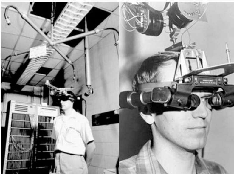
Slika 2, VR slušalice koje je razvio Ivan Sutherland, "Sword of Damocles" Izvor: https://etsanggarp.blogspot.com/2016/03/
