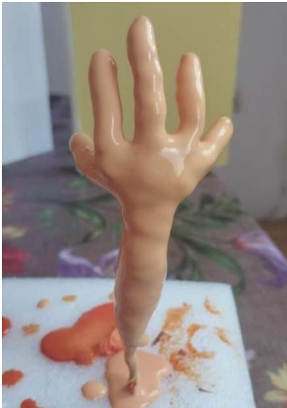
Slika 55. Ruka nakon premazivanja obojanim lateks mlijekom – prije sušenja
