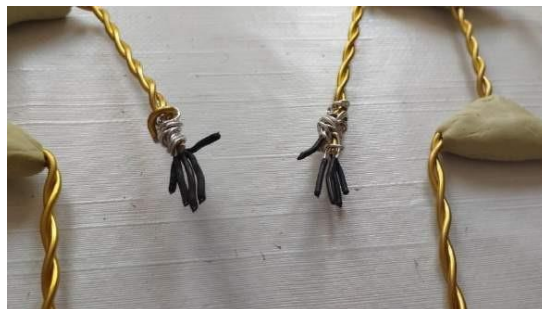
Slika 15. Termo bužir na žicama za prste
