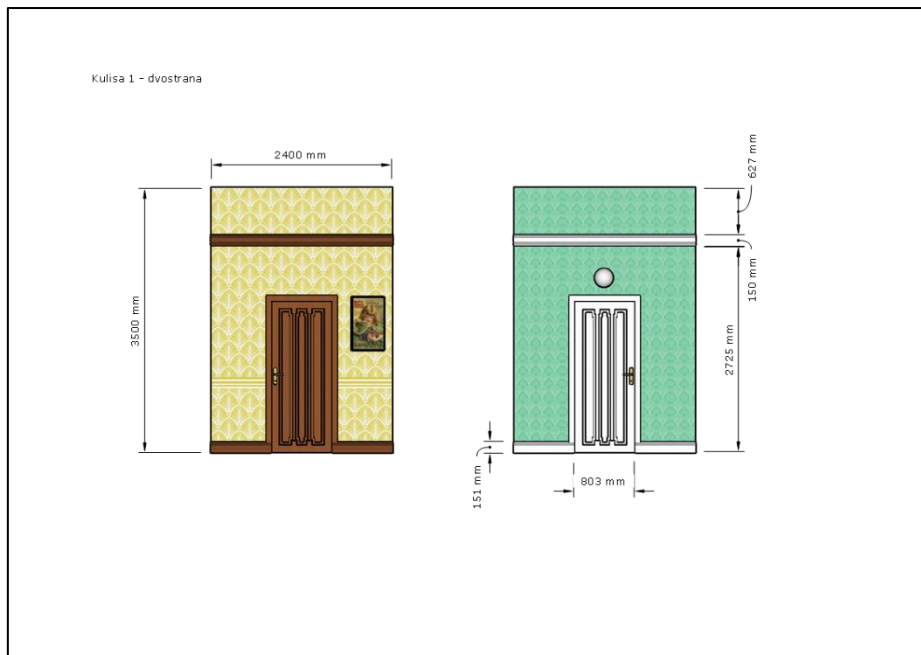
Slika 16. Tehnički nacrt vanjskih kulisa
