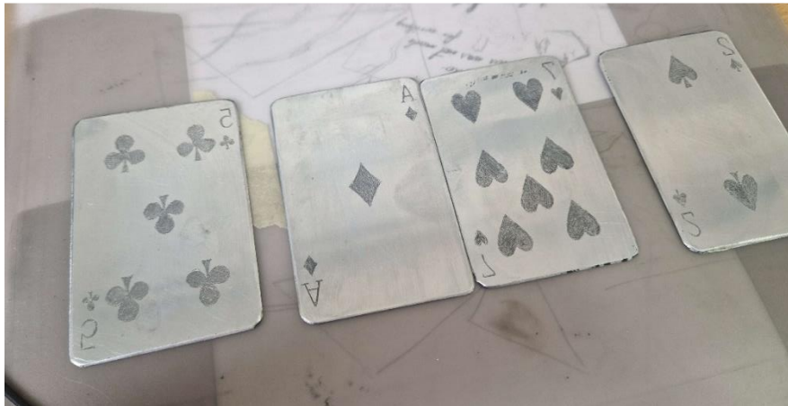
Slika 7. Primjer grafičkih ploča nakon jetkanja
