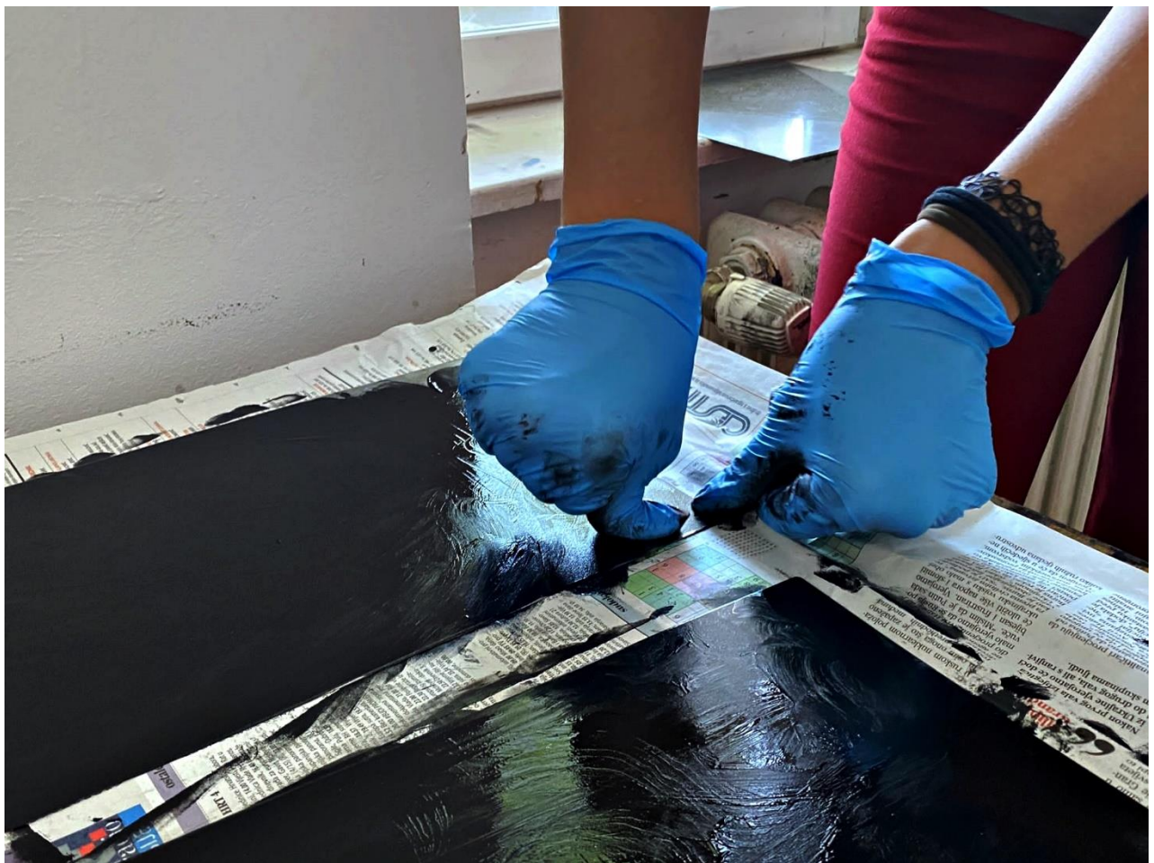
Slika 17. Nanošenje tiskovne boje na ploče
