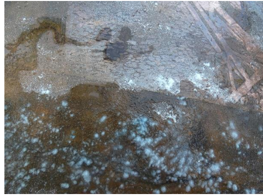
Slika 43. i Slika 44. Proces čišćenja bakra alkoholnim octom i sodom bikarbonom
