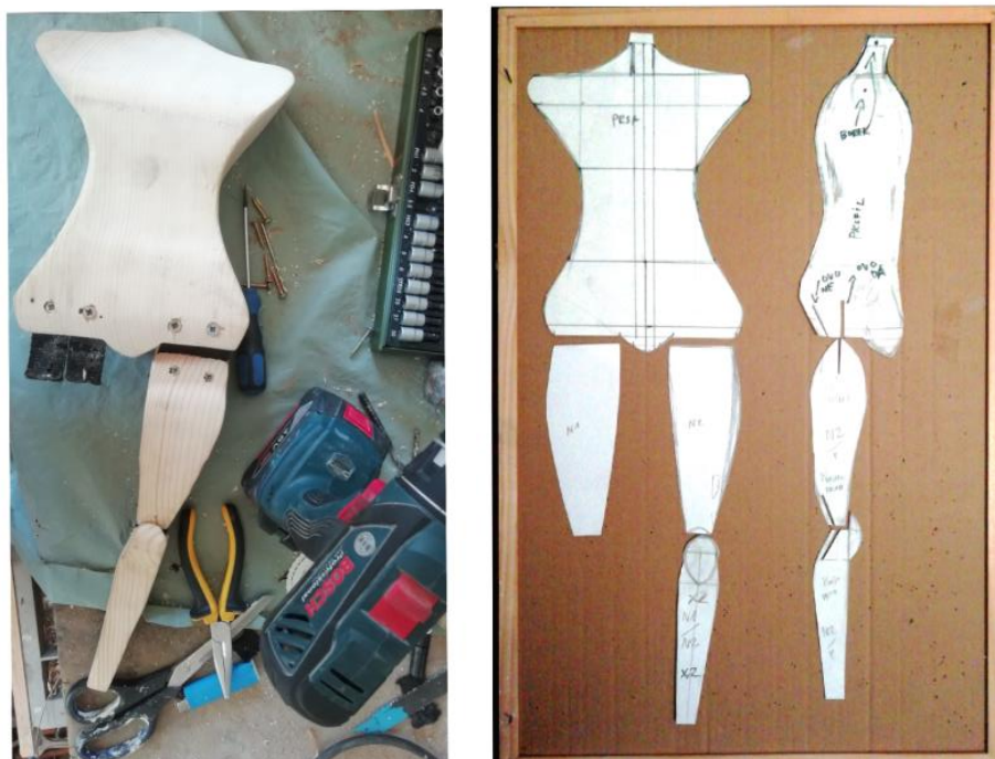
Slika 32. Primjer izrade tijela lutke
