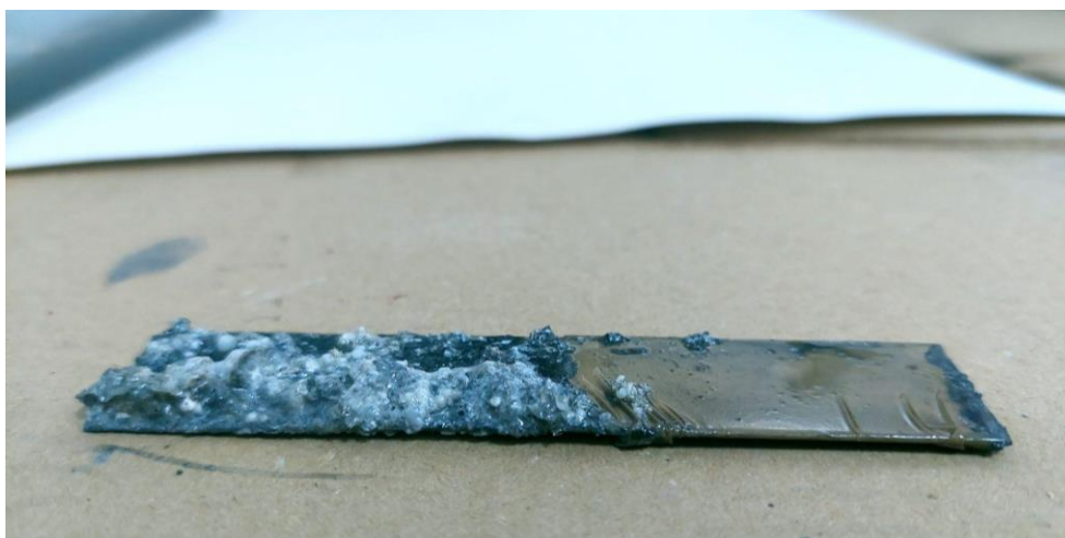
Prilog 44: Pločica nakon pet dana u fiksiru
