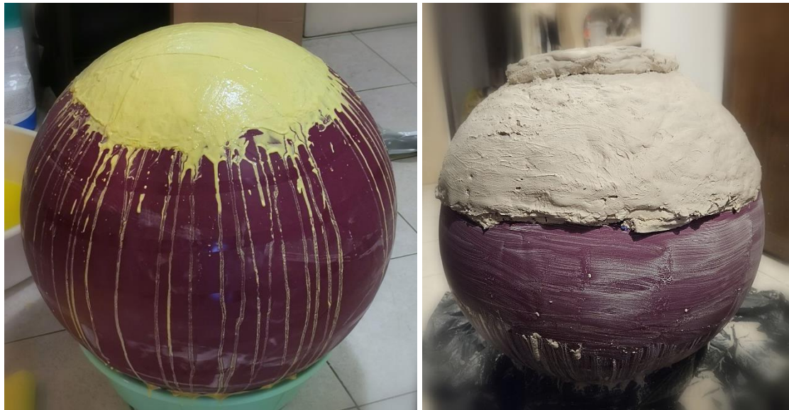
Slika 27; Slika 28 – Izrada kalupa od gipsanih traka i gipsa
