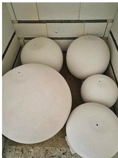
Slika 34 – Biskvitno paljenje radova u peći
