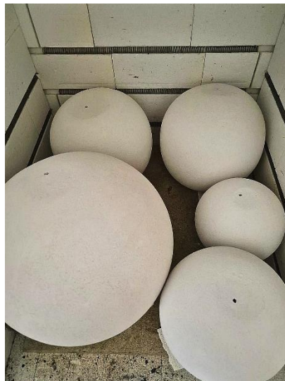
Slika 34 – Biskvitno paljenje radova u peći
