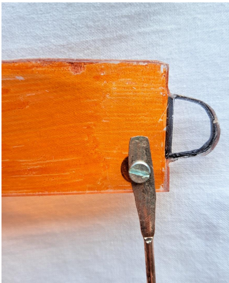
Slika 13. Krupni prikaz spoja vodilice i ruke s prednje strane
