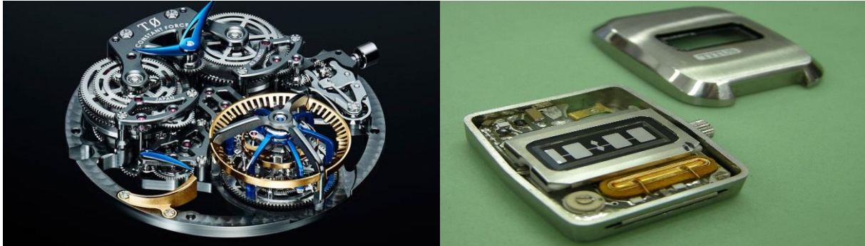
Slika 1 – Razlika između radnih jedinica analognog i digitalnog sata (Watch-a-porter, 2022) (Pinterest, 2016)
