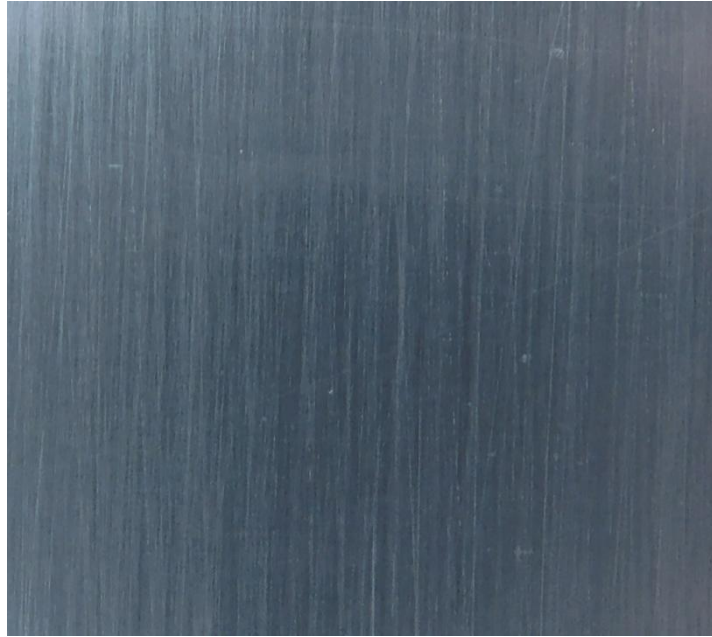
Prilog 10. Detalj površine cinka nakon grubog poliranja
