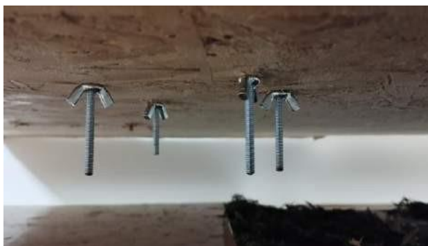
Slika 46. Matice i vijci za učvršćivanje lutke
