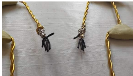
Slika 15. Termo bužir na žicama za prste
