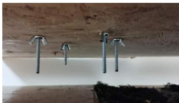
**Slika 46.** Matice i vijci za učvršćivanje lutke
