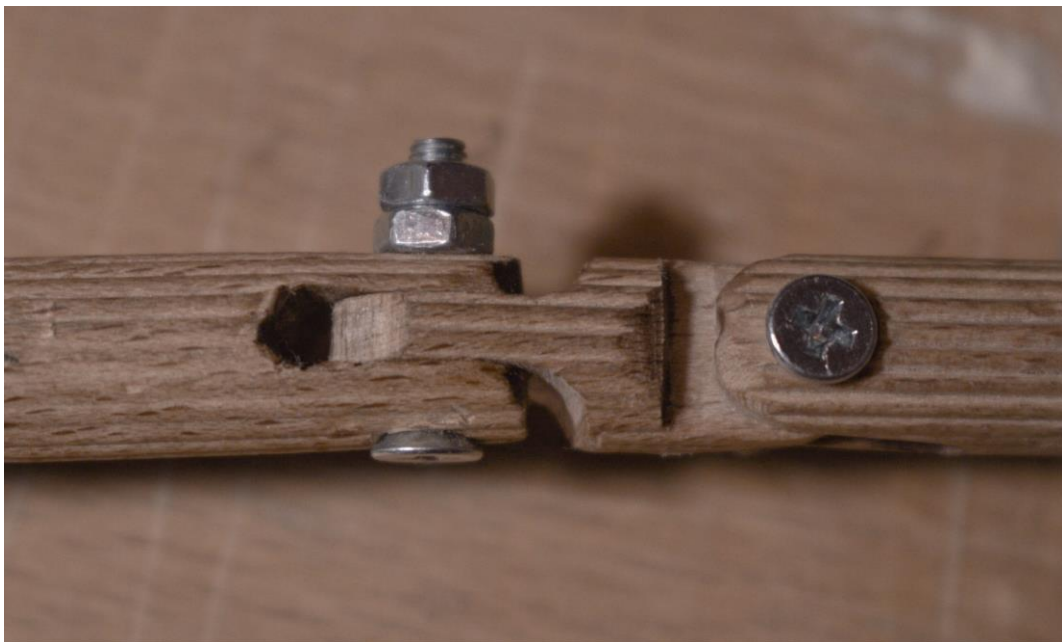
Slika 16: Prikaz spojeva za pomicanje kralježnice
