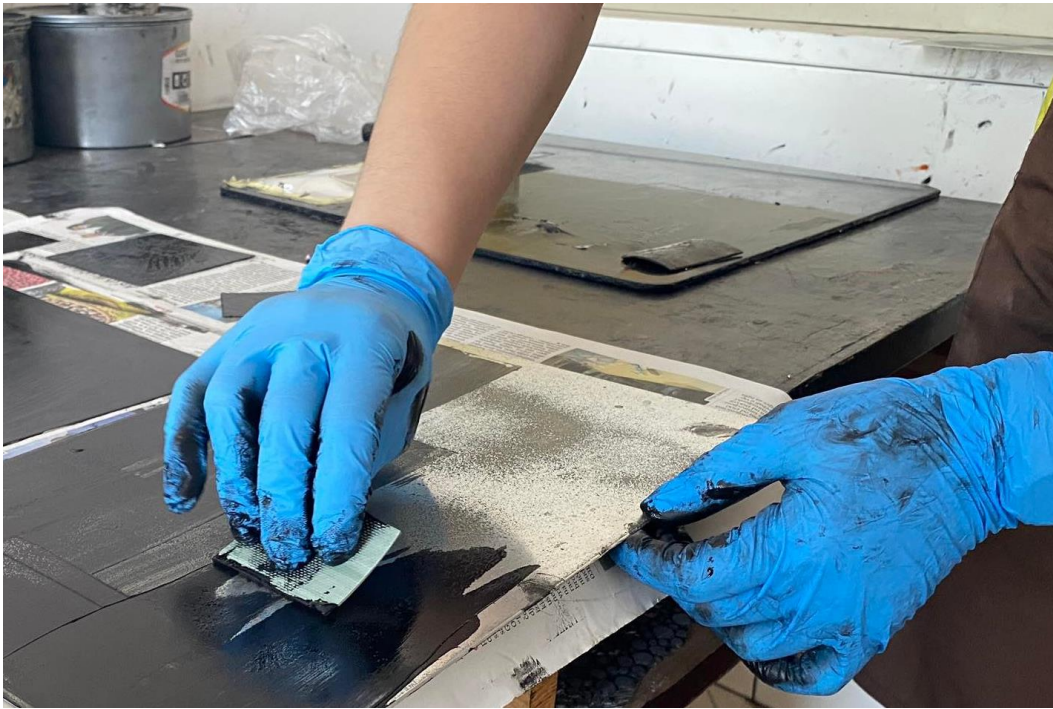
Slika 13. Nanošenje boje na ploču
