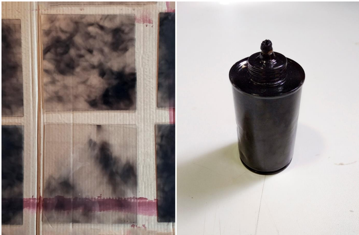
Slika 12. Načadena stakla (lijevo) i dio baklje za komarce korišten za čađenje (desno).
