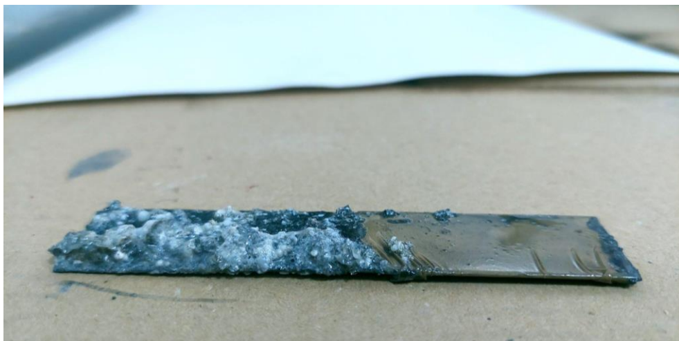
Prilog 44: Pločica nakon pet dana u fiksiru
