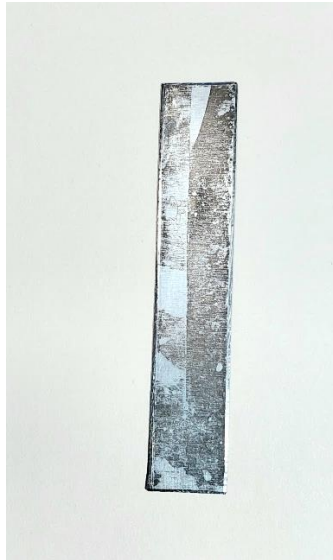
Prilog 43: Reakcija fiksira na cinčanu pločicu - 3 sata u fiksiru
