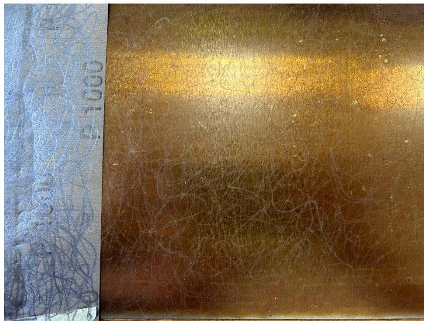
Slika 11. Detalj na matrici nakon tehnike brusnim papirom
