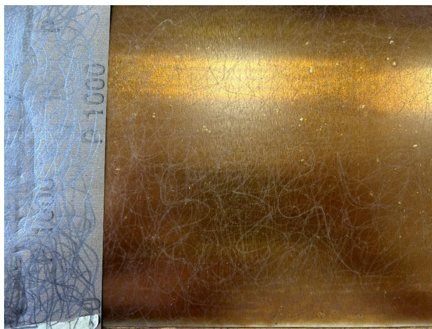
Slika 11. Detalj na matrici nakon tehnike brusnim papirom
