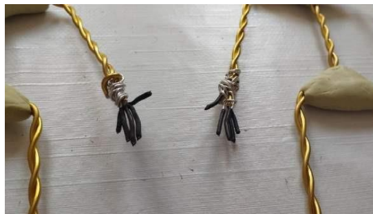
Slika 15. Termo bužir na žicama za prste
