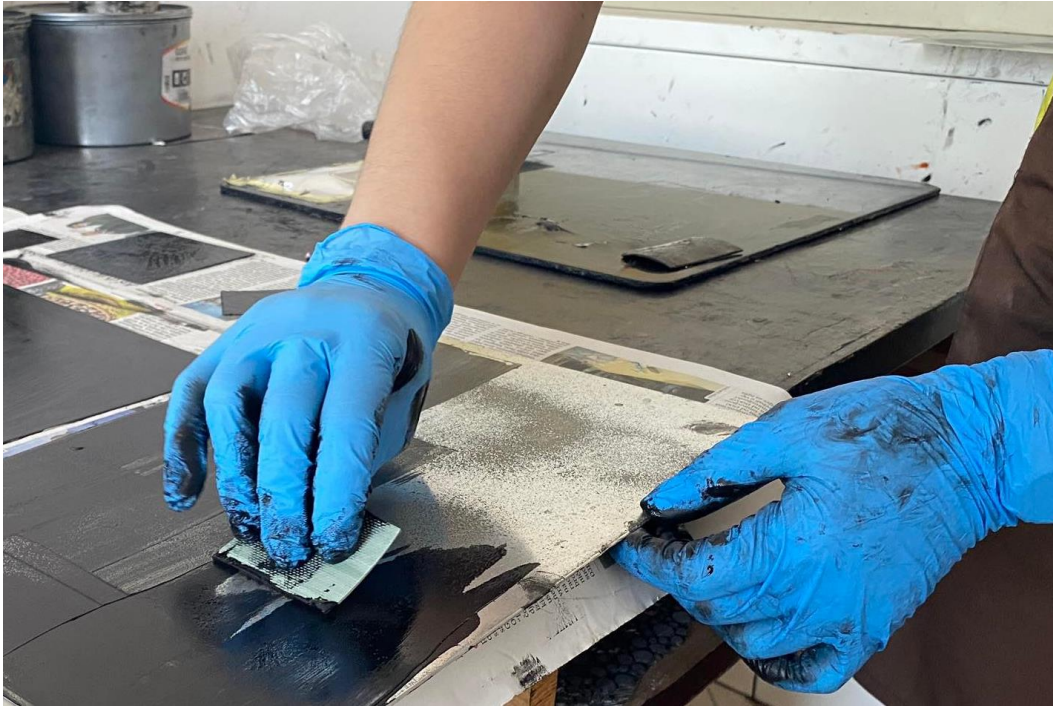
Slika 13. Nanošenje boje na ploču
